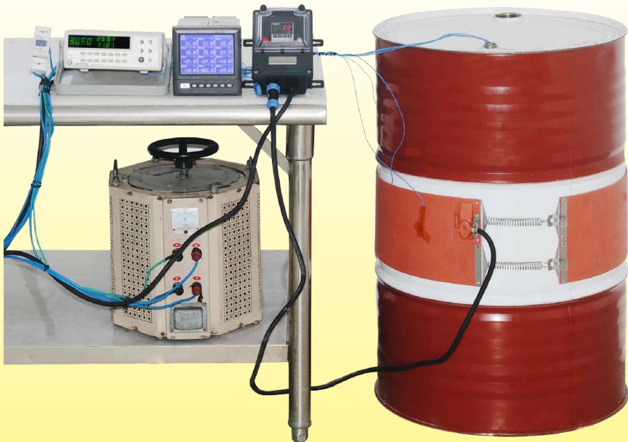
Temperaturverlauf in Abhängigkeit von der Zeit eines 220Liter-Metallfasses, gefüllt mit Wasser, beheizt durch einen Silikonheizgurt 200mm breit, ohne Wärmeisolation, Leistung 1500W (Oberflächenlast 0,5W/cm²).
